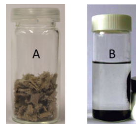
Abbildung 7. Holocellulosefraktionen, die aus zwei unterschiedlichen vorgeschalteten nickelkatalysierten Verfahren abgeleitet sind: A) durch Raney-Ni katalysierte Entfernung von Lignin aus Pappelholzspänen (der Zellstoff ist für die weitere nachgeschaltete Behandlung geeignet). [198] B) Ni/C-katalysierte Entfernung von Lignin aus Birkenholzsägemehl (der Zellstoff ist nicht für die enzymatische Hydrolyse geeignet). [281] Abdruck von (A) mit Genehmigung aus Angew. Chem. Int. Ed. 2014 , 53, 8634–8639; Angew. Chem. 2014 , 126, 8778–8783. Copyright 2014 John Wiley and Sons. Abdruck von (B) mit Genehmigung aus Energy Environ. Sci. 2013 , 6, 994–1007. Copyright 2013 Royal Society of Chemistry.
